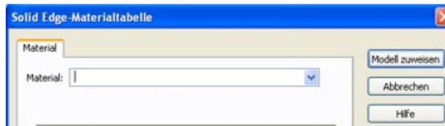
Die Teile erhalten dann auch schon die Farbe des Materials. Der Teil ist dann durch und durch aus diesem Material. Er erscheint auch in eventuell angefertigten Stücklisten mit diesem Material.
