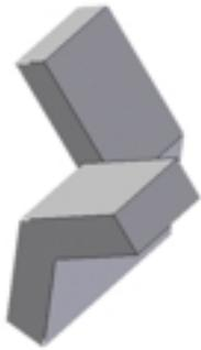
Das Objekt setzt sich aus zwei kongruenten Teilen zusammen, sie gehen durch Drehung um  $180^\circ$  ineinander über. Daher kann man hier mit dem Befehl Muster arbeiten. Man beginnt mit einer Ausprägung, um den ersten Teil zu modellieren.
