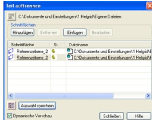
**Der Körper wird mit einer Ebene durchtrennt. Beide entstandenen Schnittkörper können abgespeichert werden.**
