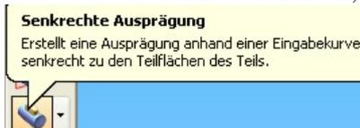
Wähle danach Senkrechte Ausprägung. Dieser Befehl befindet sich im Flyout von Rotationsausprägung. Wähle dann jeden Buchstaben deines Schriftzuges bis der ganze Schriftzug markiert ist, bestätige wieder. Gib danach die Ausprägungshöhe ein.
