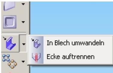
Wähle dann den Befehl „Ecke auftrennen“, der im Flyout von „in Blech umwandeln“ vorhanden ist. Wähle danach alle Kanten, entlang derer du den Würfel aufschneiden müsstest, um ihn zu verebnen. Das sind hier die schwarz nachgezogenen Kanten.
