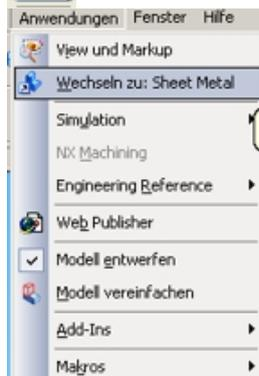
Wenn das Objekt fertig konstruiert ist, gehe zu Anwendungen/ Wechseln zu Sheet Metal.
