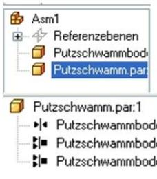
Hast du die Teile fertig ausgerichtet, klicke in der Edge Bar auf den Assembly Path Finder, das zweite wichtige Symbol.
