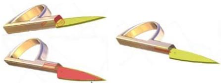
Als ersten Baustein lädt man den Griff. Die Schneide ( Schere ) kommt als 2. Teil und wird 3 Mal mit der Beziehung An-Aufsetzen in der Öffnung des Griffs fixiert. Wähle die Beziehung An- aufsetzen direkt! FlashFit Macht zu viele Fehler und es ist mühsam diese zu korrigieren.
