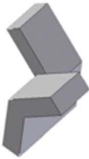
Das Objekt setzt sich aus zwei kongruenten Teilen zusammen, sie gehen durch Drehung um  $180^\circ$  ineinander über. Daher kann man hier mit dem Befehl Muster arbeiten. Man beginnt mit einer Ausprägung, um den ersten Teil zu modellieren.
