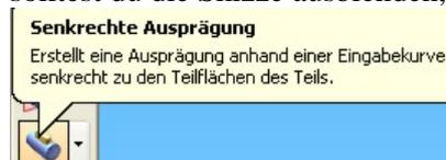
Wähle danach Senkrechte Ausprägung. Dieser Befehl befindet sich im Flyout von Rotationsausprägung. Wähle dann jeden Buchstaben deines Schriftzuges bis der ganze Schriftzug markiert ist, bestätige wieder. Gib danach die Ausprägungshöhe ein.
