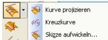
Im Flyoutmenü bei Kurve Projizieren ist auch der Befehl Skizze aufwickeln versteckt. Wähle dann zuerst den Zylinder, bestätige mit Haken oder mit der Entertaste.
